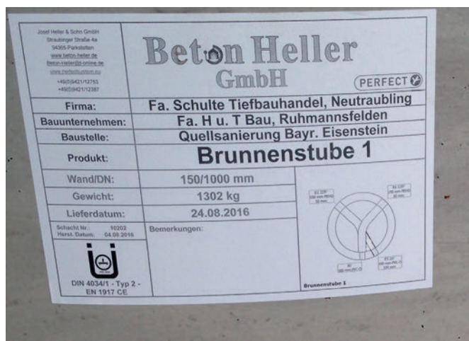
Наклейка на готовом каптаже содержит данные обо всех важных параметрах изделия и проекта
