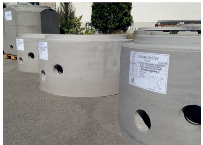
Бетонные каптажи с заводскими интегрированными уплотнениями и перепускными шахтами компании Heller перед отправкой на стройплощадку
