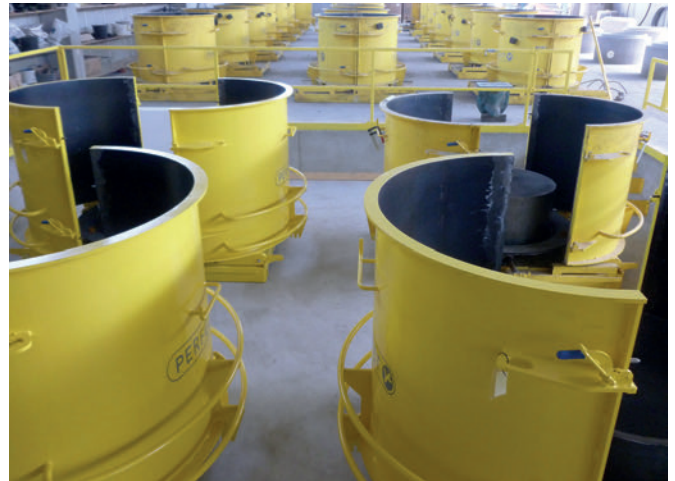
Простые в обращении стальные формы для производства элементов с индивидуальной конфигурацией водоводов по технологии твердения в опалубке
