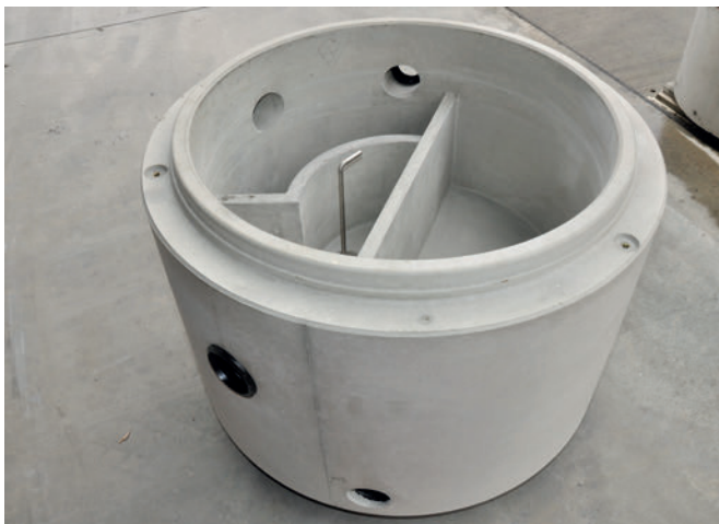
Каптаж из самоуплотняющегося бетона диаметром DN1200 с индивидуальной конфигурацией водовода и замоноличенным уплотнением
